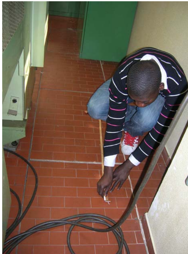
Griglia su pavimento per poter segnare i punti di misura
